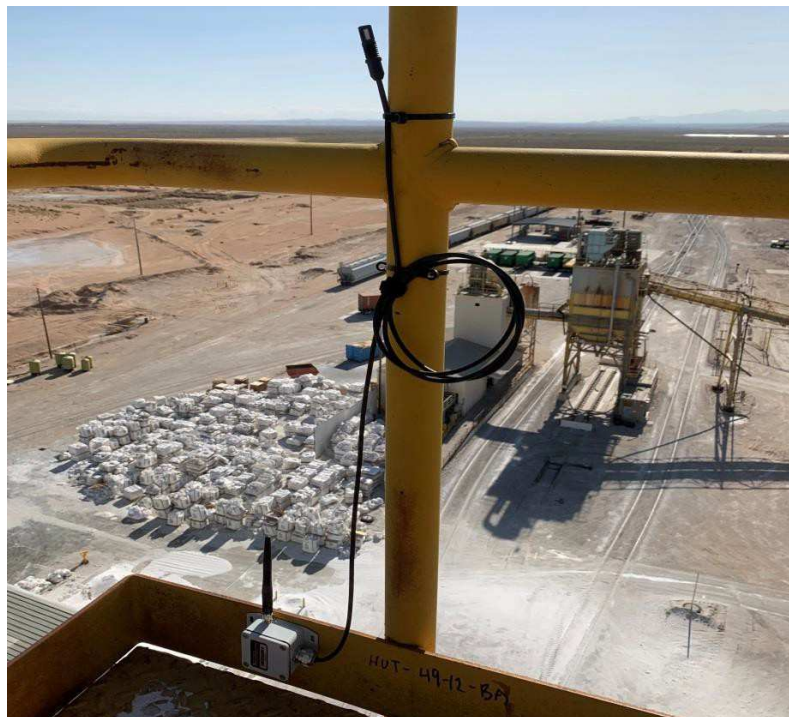
Slika 3: Resensis bežični Humiditi-Temperature SenSpot™ instaliran na zgradi unutar rudarskog objekta
