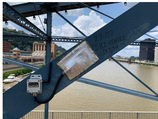
Bežični merač naprezanja SenSpot™ na nosaču mosta
