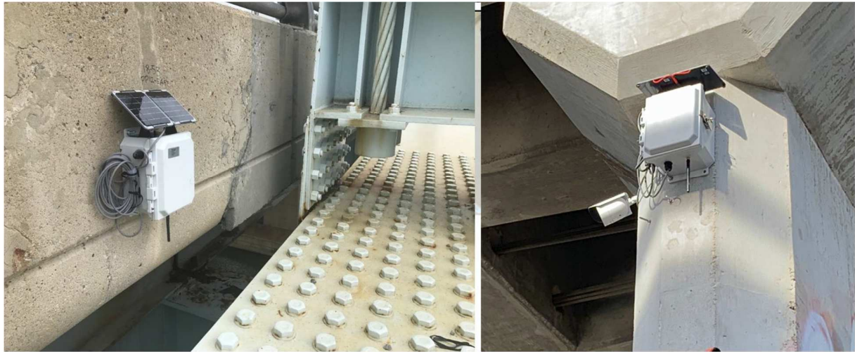
Slika 4: Instalirani Senimak™ (levo) i Senimak sa kamerom (desno)
