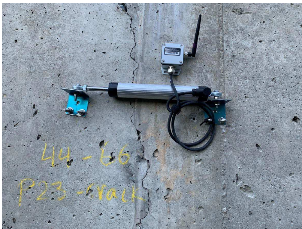
Slika 4: Instaliran merač pukotina SenSpot™ na betonskoj strukturi za praćenje razvoja širine pukotina
