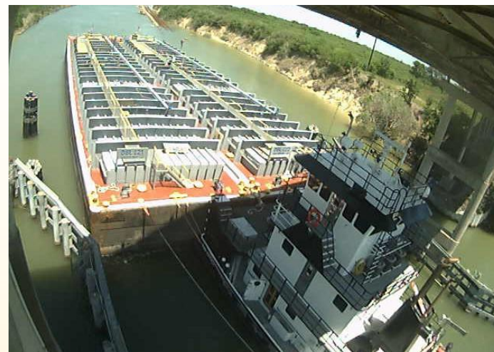
Tipična slika snimljena bežičnom solarom kamerom koja pokazuje vidno polje kada plovilo udari u branu/delfine/stubove mosta. (Ova vrsta slike ima vremenski žig)
