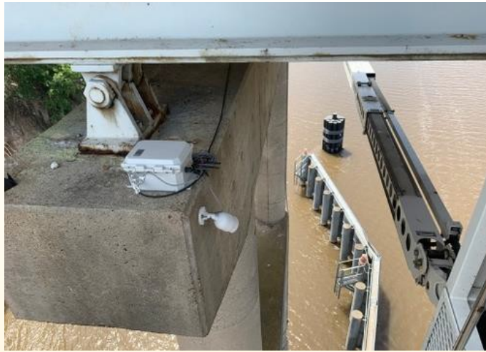
Bežične solarne kamere na mostovima za otkrivanje i praćenje sudara plovila. Kamera snima brod nakon što su bežični akcelerometri otkrili udar
