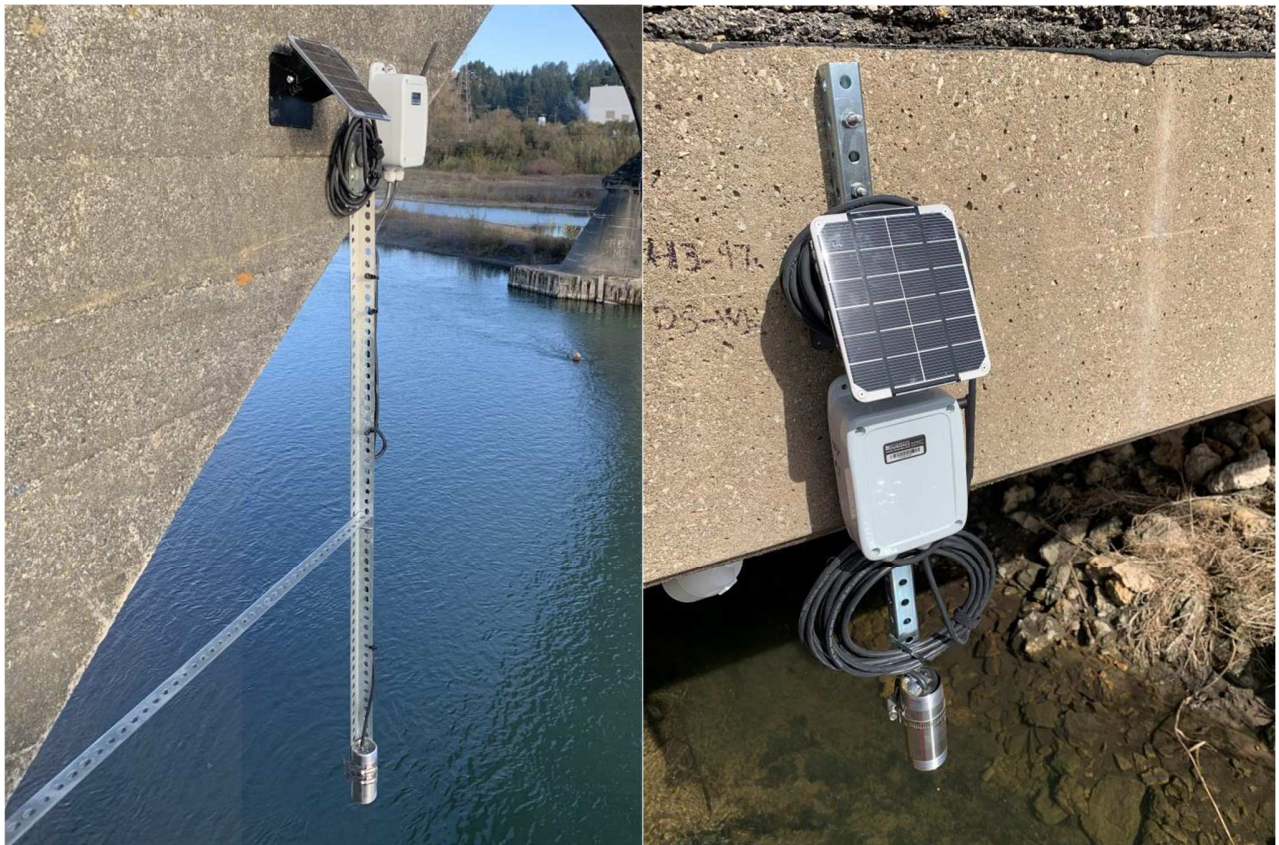
Slika 4: fotografije instaliranog Resensis ultrazvučnog vodomera SenSpotTM.
