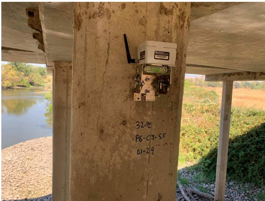
Slika 4: A Resensys 2DHRT SenSpotTM postavljen na šip mosta
