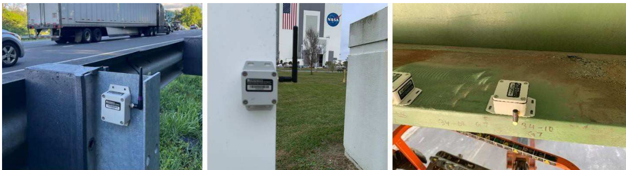
Slika 4: SenSpot™ senzori Resensis akcelerometra visokih performansi (HPA) instalirani na infrastrukturi
