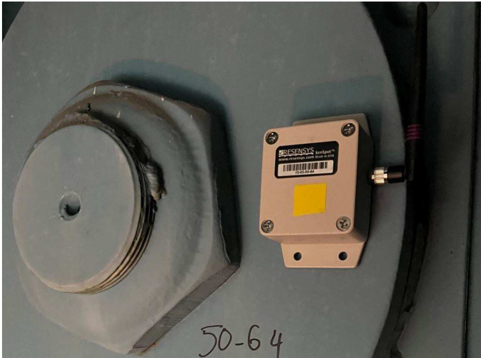
Slika 4: Resensis 2DMRT SenSpot™ instaliran na ležaju mosta
