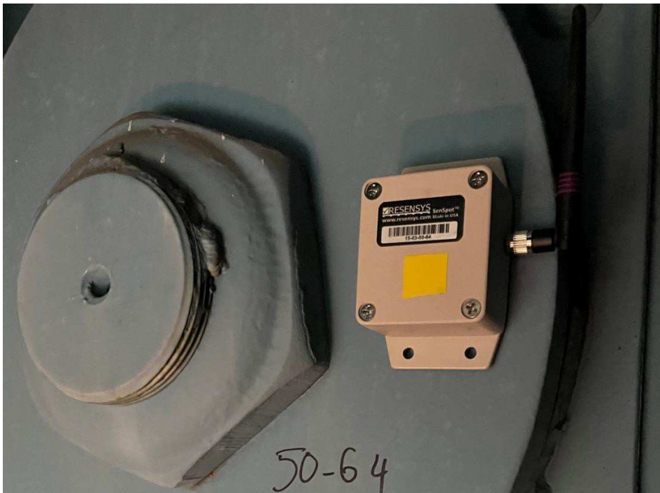
Slika 4: Resensis 2DMRT SenSpotTM instaliran na ležaju mosta
